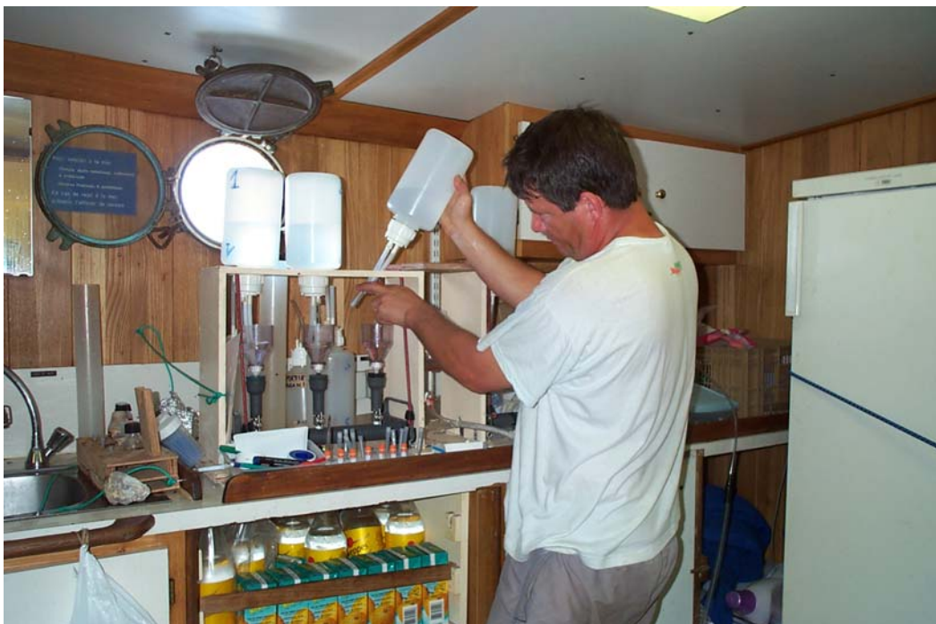
rampe de filtration
