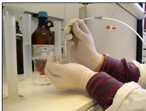
photo 13 : extraction par l'hélium
